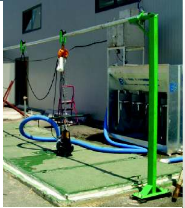
Σύστημα ανύψωσης-καθίζησης και μετατόπισης βυθιζόμενης αντλίας
